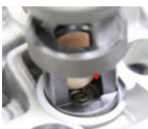
รูปที่ 2 ขั้นตอนการประกอบลิ้นวาล์วเข้ากับก้านวาล์ว
