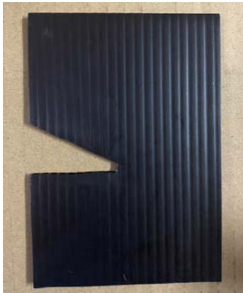
รูปที่ 5 เกจวัดใช้ทดสอบเวอร์เนียคาลิเปอร์
