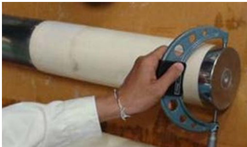
รูปที่ 6 การวัดขนาดของลูกสูบเซรามิกด้วยไมโครมิเตอร์
