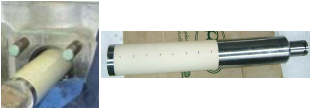
รูปที่ 5 การประกอบชุดลูกสูบเข้ากับปั๊มแรงดันสูง
