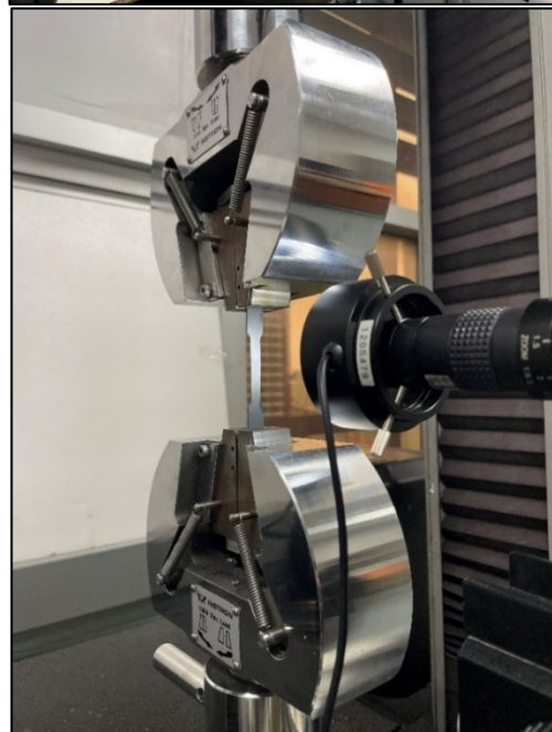
รูปที่ 1 ชุดทดสอบแรงดึงเพื่อศึกษาสภาพการยึดติดของออกไซด์สเกลบนเนื้อพื้นโลหะ
