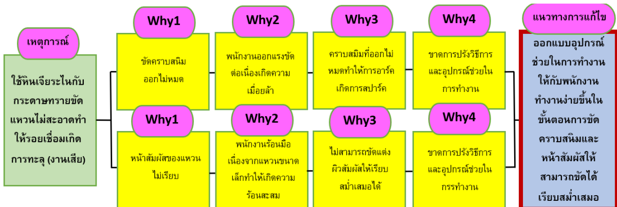
รูปที่ 10 การวิเคราะห์ปัญหาและกำหนดแนวทางการแก้ไขด้วย Why-Why Tree Diagram
