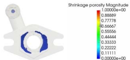
รูปที่ 8 แบบจำลองการเกิดโพรงหดตัวของชิ้นงานรูล้นทรงกระบอกกลางหนา 8 มิลลิเมตร (shrinkage porosity = 1.925 %)
