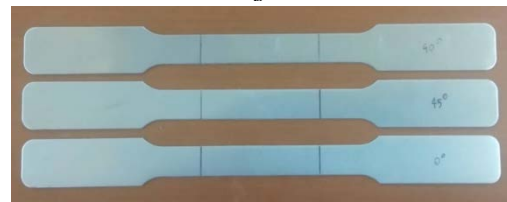
ข. ชิ้นงานที่ใช้ในการทดสอบหาคุณสมบัติทางกลของวัสดุ
