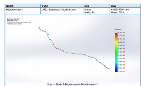
รูปที่ 16 ค่าการกระจัดของการต่อสายพานแบบใหม่ (การกระจัด = 0 - 0.00837741mm.)
