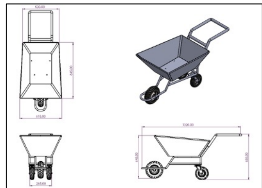
รูปที่ 2 แบบปรับปรุงของรถเข็นที่ใช้ในงานก่อสร้าง
