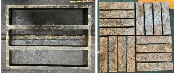
รูปที่ 8 แม่พิมพ์จากซีเมนต์อย่างพาราผสมเส้นใยเปลือกมะพร้าว
