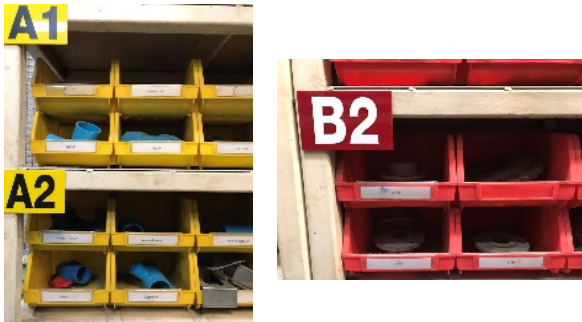
รูปที่ 4 การติดป้ายตำแหน่งบน Rack แต่ละ location
