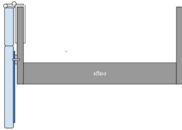
รูปที่ 2 (ก) Front view ร่างต้นแบบของโต๊ะขณะใช้งาน และ (ข) ขณะพับเก็บหรือไม่มีการใช้งาน
