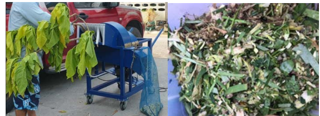
รูปที่ 8 ทดสอบอัตราการย่อยของเครื่องย่อยกิ่งไม้-ใบไม้
