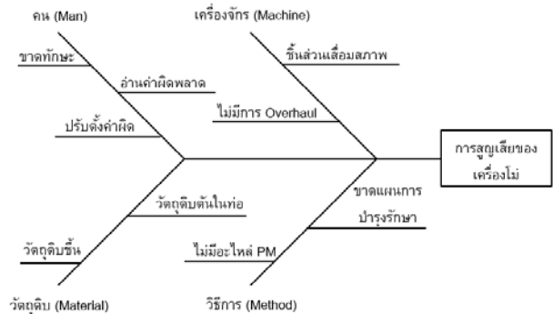
รูปที่ 1 แผนผังก้างปลาปัญหาการสูญเสียของเครื่องโม่
