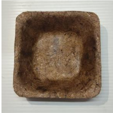
รูปที่ 7 ภาชนะบรรจุอาหารจากเส้นใยกาบมะพร้าวผสมผงพอลิเอทิลีน
