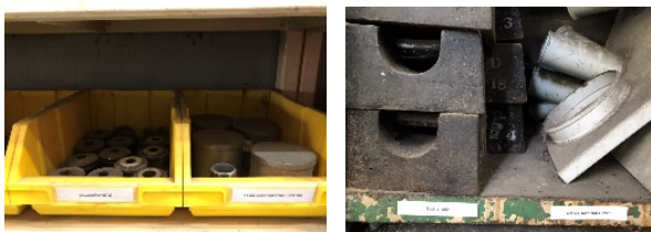
รูปที่ 5 การติดป้ายบ่งบอกชนิดของอะไหล่ที่อยู่ใน Bin
