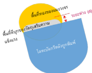
รูปที่ 6 ภาพแสดงระยะห่างการพิมพ์โลหะบัดกรีบนพื้นที่เปิด
