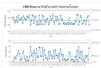
รูปที่ 15 แผนภูมิควบคุม I-MR Chart ของปริมาณสารละลายน้ำทั้งหมด
