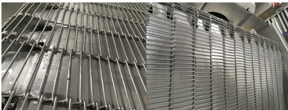
รูปที่ 11 การต่อสายพานแบบเก่า (แบบดัด)
