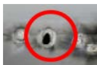
รูปที่ 3 รอยทะลุจากการเชื่อมแหวนอีแปะ
