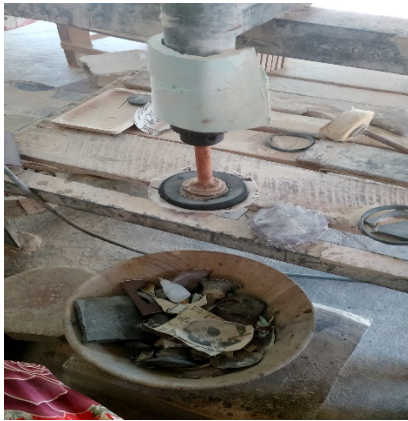
รูปที่ 3 เครื่องตัดที่ติดตั้งจุกกระดาษทราย และดึงใส่จุกกระดาษทราย
