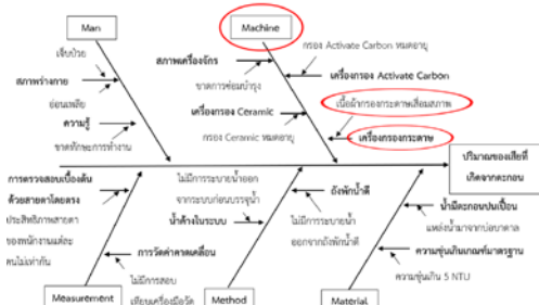
รูปที่ 5 แผนผังกิ่งปลาแสดงเหตุและผลของปัญหาของเสียที่เกิดจากปริมาณของเสียที่เกิดจากตะกอน
