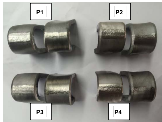
รูปที่ 10 ชิ้นงานที่ผ่านการทดสอบการดัดโค้ง
