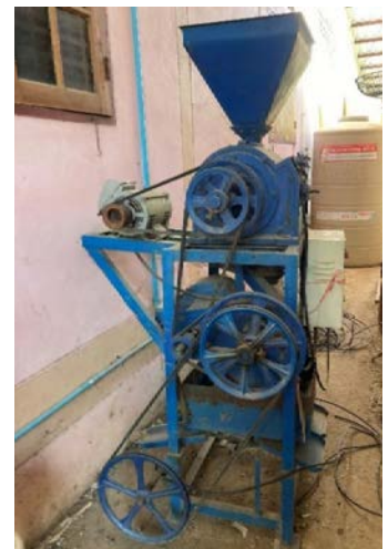
รูปที่ 1 แสดงระบบส่งกำลังของเครื่องกะเทาะเมล็ดกาแฟ
