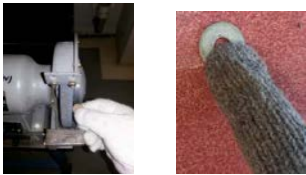
รูปที่ 8 วิธีการทำความสะอาดแหวนอีแปะวิธีเดิม
