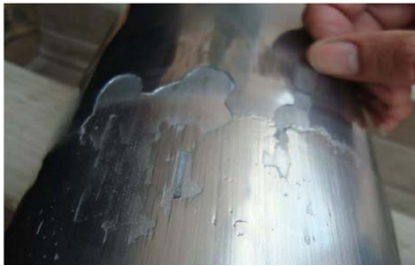
รูปที่ 4 ผิวลูกสูบที่เสียหายจากการเสียดสีและการกัดกร่อน
